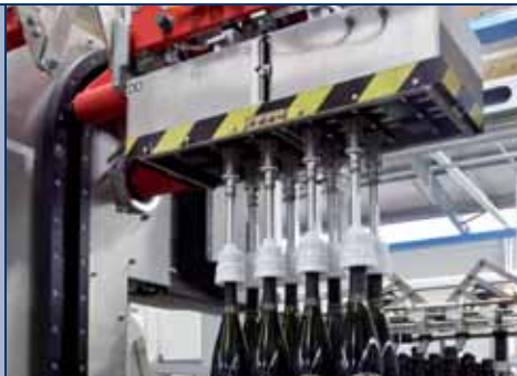
Movimento meccanico radiale comandato da inverter Radial mechanical movement controlled by inverter Mouvement radial mécanique contrôlé par convertisseur de fréquence
