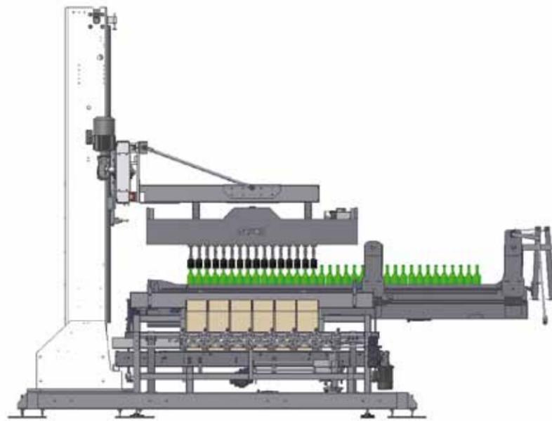
Incartonatrice con movimentazione a 2 assi. 4 teste di presa e separatori autoregolanti motorizzati gestiti direttamente da programma. Attrezzature multiformato per bottiglie da diametro 62 mm a 116 mm.
